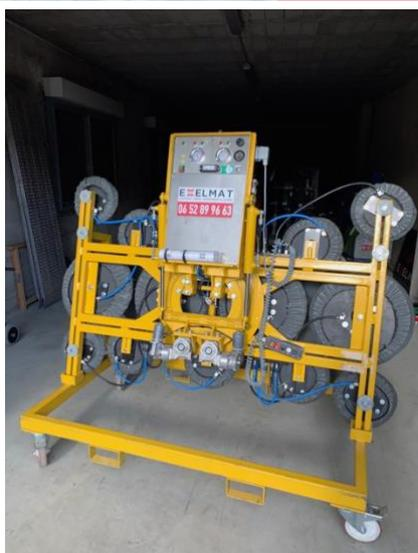
La conception robuste du DSMH2 et son système composé notamment de 2 circuits de vide conformément à la norme EN13155 en font un palonnier d'utilisation facile et très efficace. L'équipement est pourvu de témoins visuels et sonores et d'une gestion automatique du vide d'air en cas de manque ou de perte. La position des ventouses est réglable en hauteur ou en largeur pour les rallonges. Elles sont déconnectables par raccord pneumatique rapide.
