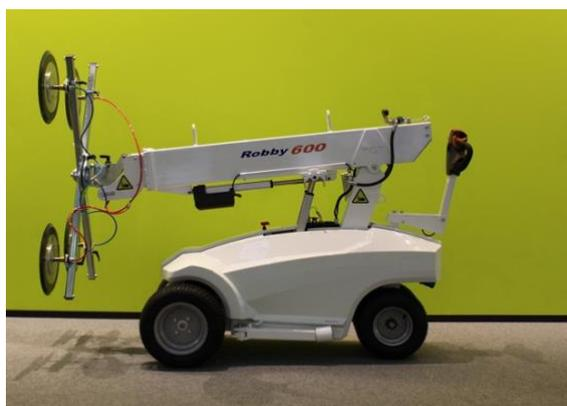
Le ROBBY 600 dispose de 4 fonctions électriques dont le déplacement latéral et le basculement. Ses roues souples lui permettent une facilité de transport des vitrages sur chantier. Ses batteries lui assurent une autonomie de 16 heures.
